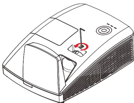
Para deslocar a imagem projetada para cima, rode os parafusos de ajuste no sentido inverso ao dos ponteiros do relógio.
