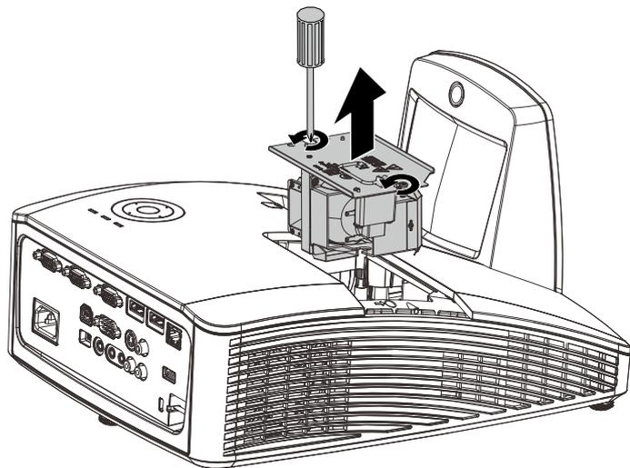
5. Puxe firmemente pela pega do módulo para remover o módulo da lâmpada.
