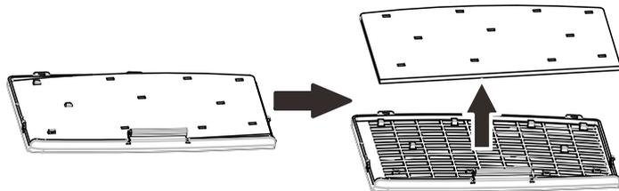
3. Substitua por um novo módulo de filtro ou volte a colocar o filtro na tampa.
