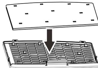
4. Volte a colocar a tampa do filtro no projector pressionando cuidadosamente na direcção indicada.
