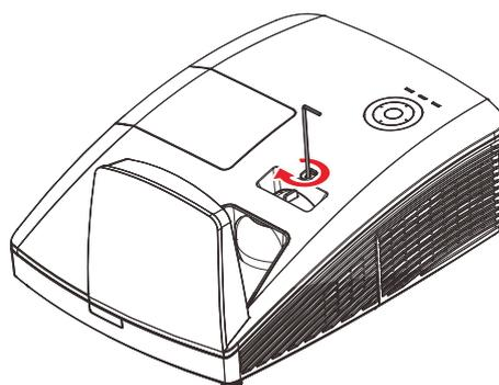
Para deslocar a imagem projetada para baixo, rode os parafusos de ajuste no sentido dos ponteiros do relógio.
